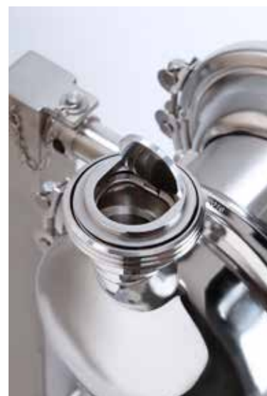
Rysunek 3: Zawór klapowy jest całkowicie otwarty i medium przepływa swobodnie. Te cykle są naprzemiennie powtarzane po stronie ssawnej i tłocznej pompy.
