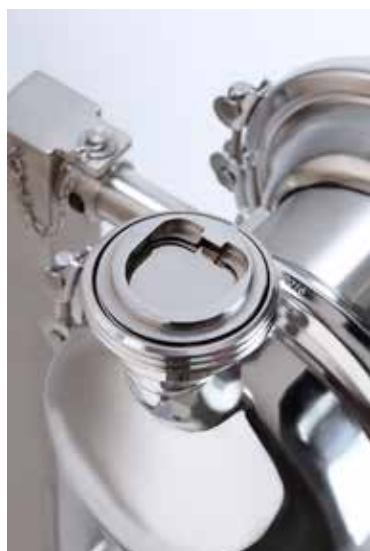
Rysunek 1: W chwili rozruchu zawór klapowy po stronie ssawnej jest otwierany, a po stronie tłocznej – zamykany. Rysunek 1 prezentuje stronę tłoczną jednej komory pompy.
